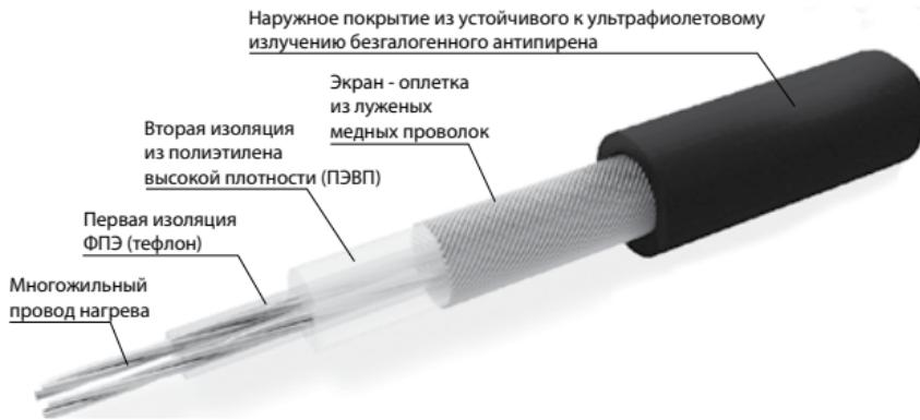
Конструкция кабеля нагревательного мата
