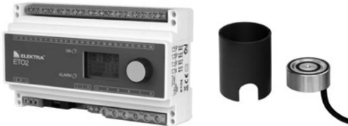
Терморегулятор ELEKTRA ETO2G предназначен для управления емкими системами антиобледенения наружных территорий (рассчитан на 3x16 А). Комплектуется одним датчиком температуры и влажности с цилиндрическим основанием, но само устройство рассчитано на две зоны, т.е. существует возможность подключить дополнительный датчик. В зависимости от типа выбранного второго датчика, терморегулятор
