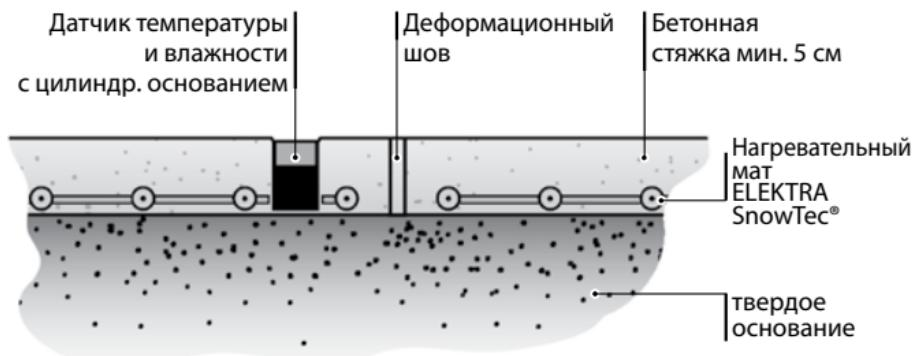
Поперечное сечение тротуара или подъездных путей, изготовленных из бетонной стяжки
