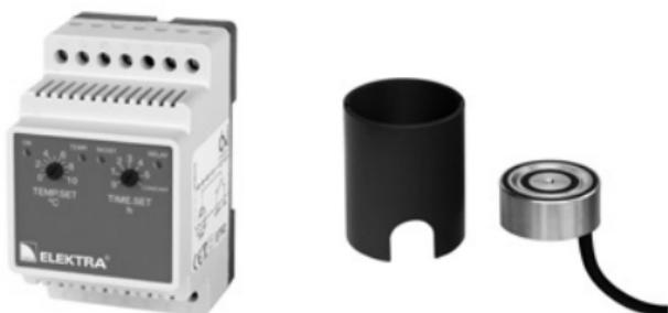
Regulator ELEKTRA ETR2G – obciążalność 16 A – łączna moc zainstalowanych przewodów grzejnych nie powinna przekraczać 3600 W. Standardowo wyposażony w jeden czujnik temperatury i wilgoci z tuleją montażową.
