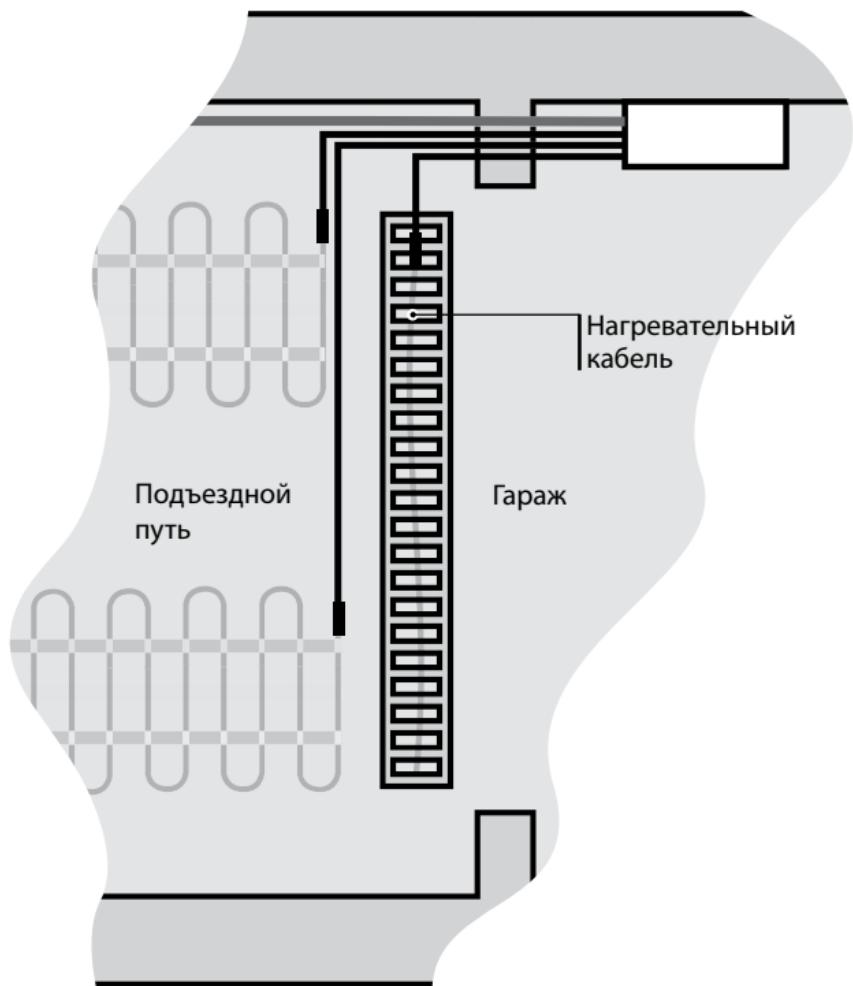
Кроме того, необходим подогрев дренажной решетки для отвода воды, которая появляется в результате таяния снега. Для этой цели используется саморегулирующийся нагревательный кабель ELEKTRA SelfTec® PRO 33. Кабель должен быть размещен в нижней части дренажной канавы и введен в канализацию на глубину около 0,5 - 1,0 м.
