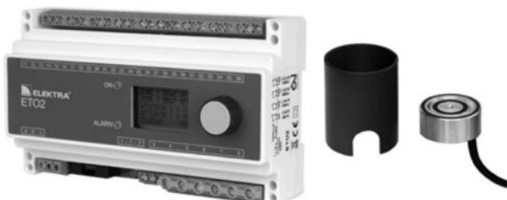
Regulator ELEKTRA ETO2 – obciążalność 3x16 A. Stosowany w dużych instalacjach. Standardowo wyposażony w jeden czujnik temperatury i wilgoci oraz tuleję montażową. Do sterownika można podłączyć drugi, dodatkowy czujnik temperatury i wilgoci, co pozwoli na ochronę dwóch powierzchni zewnętrznych. Istnieje możliwość sterowania dwóch niezależnych obszarów, np. zjazdu do garażu oraz rynien, za pomocą jednego sterownika.
