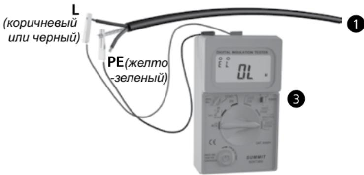
Измерение сопротивления изоляции
