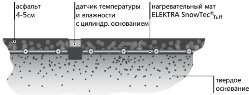
**Поперечное сечение дороги с асфальтобетонным покрытием**
