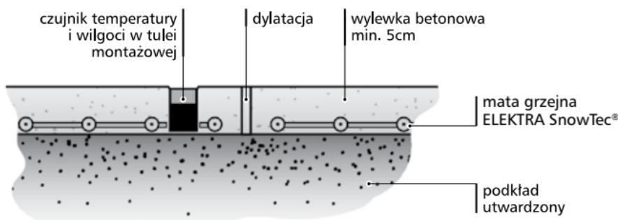
Przekrój chodnika lub podjazdu wykonanego z wylewki betonowej
