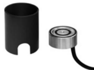
**Czujnik temperatury i wilgoci podłoża (gruntu, płyty betonowej, kostki brukowej itp.) ETOG-56T z tuleją montażową stosowany do sterowania ogrzewaniem w podjazdach, ciągach komunikacyjnych itp.**
