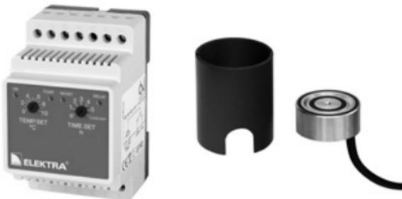
Терморегулятор ELEKTRA ETR2G рассчитан на 16А, поэтому общая мощность установленного нагревательного кабеля не должна превышать 3600 Вт. Комплектуется одним датчиком температуры и влажности. Датчик поставляется с цилиндрическим основанием.
