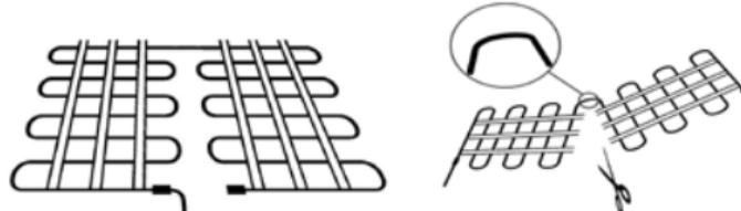
Zastosowanie izolacji termicznej w powierzchniach narażonych na działanie wiatru od spodu zwiększy efektywność ochrony. W celu ochrony przed śniegiem i lodem dużych powierzchni można zastosować maty grzejne na napięcie 400V, co spowoduje równomierne obciążenie sieci elektrycznej. Zastosowanie mat na napięcie 400V ułatwia prace montażowe – pozwala ograniczyć ilość mat grzejnych.
